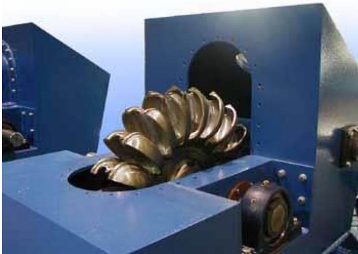
Turbina de impulso Pelton con la tapadera desmontada.
